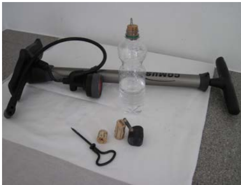
Nebel in der Flasche – Versuchsaufbau“
