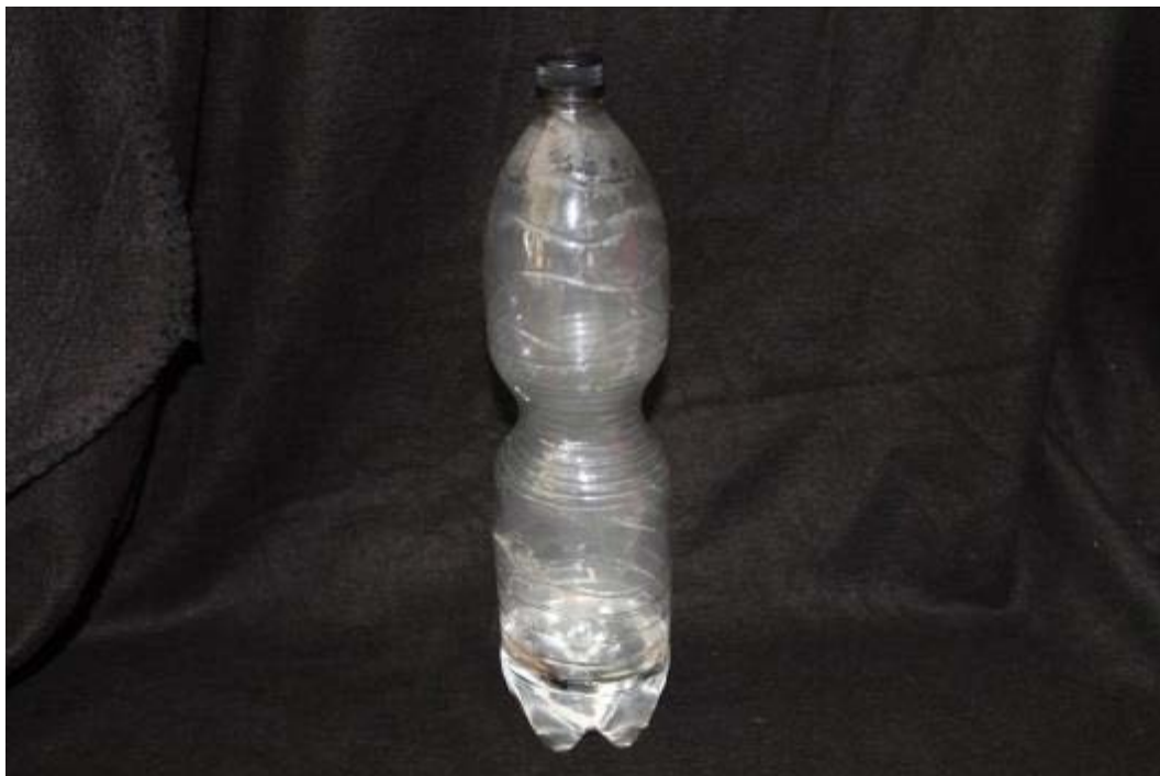
Durch Kompression und anschließende rasche Expansion erreichte Kondensation von Wasserdampf
